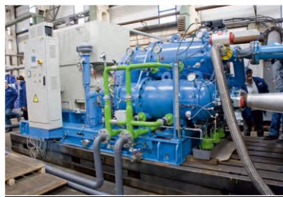
Stand de testare cu compresor CCAE 9-125 cu racire intermediara
