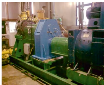
Stand de testare a compresoarelor cu surub pentru gaze naturale
