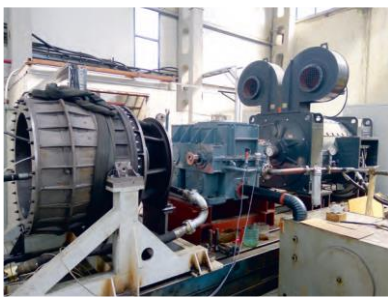
Stand de testare de 1.3 MW cu compresor MTI 1500 cu doua trepte, fara racire intermediara
